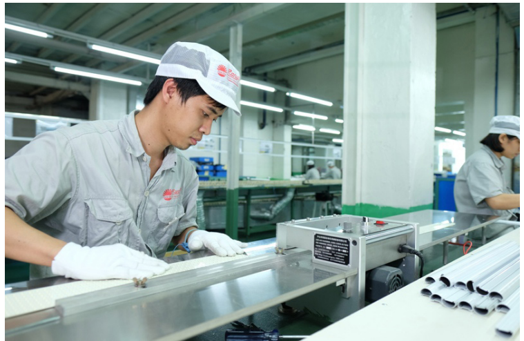
Dây chuyên sản xuất bóng đèn Led tại Cty CP Bóng đèn Phích nước Rạng Đông
